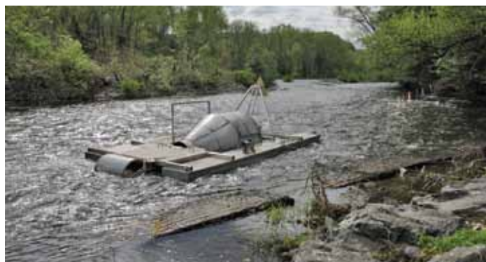
TAMBOUR À L'AVAL DE LA ZONE REFUGE
